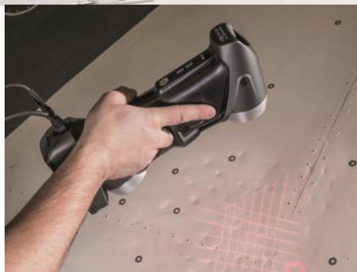
Scanner Manuale portatile per rilievi di particolari di piccole dimensioni
